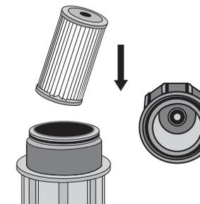
2) Coloca el cartucho de repuesto nuevo centrado y asegúrate que el cartucho asiente hasta el fondo del vaso.
