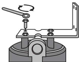
6) Con los tornillos (incluidos) fija el soporte a la tapa del Filtro con ayuda de una llave de tuercas/tornillos de 13 mm.
