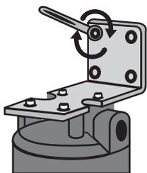
7) Fija el soporte a la pared con los tornillos utilizando la llave de tuercas/tornillos de 13 mm.
