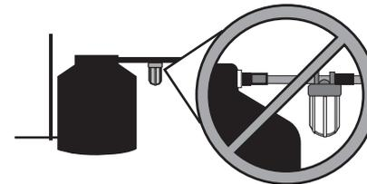
Para que corra agua limpia por toda la tubería de tu casa y se facilite el cambio del cartucho de repuesto no coloques el Filtro Jumbo junto al Sistema Mejor Agua Rotoplas.
